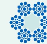
Fasereinlage Ame textile Fiber core
