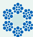
Fasereinlage Ame textile Fiber core
